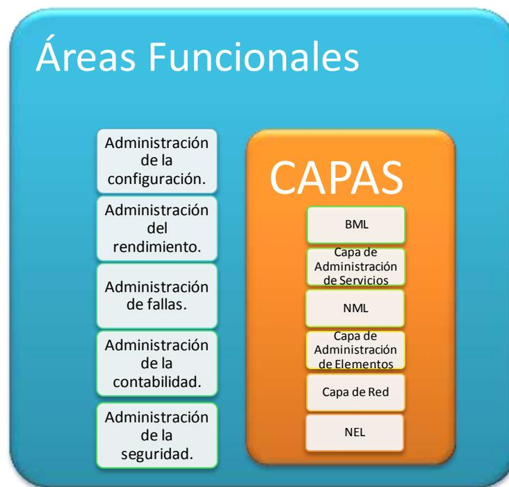
Ilustración 19: Áreas Funcionales con respecto a modelo de capas<sup>55</sup>
